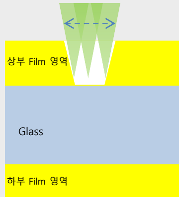
1 st Step Film Grooving (상하부 Film 제거)
